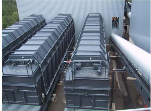
Der **Kratzerkettenantrieb** erfolgt durch aufsteckbare Getriebemotore, über Frequenzumrichter regelbar.
