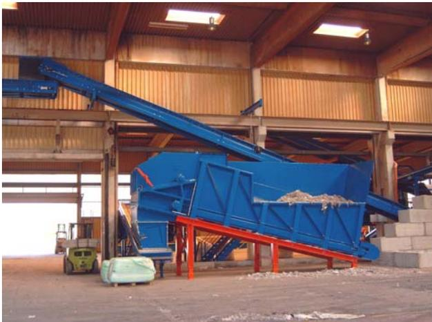
An der Abgabestelle des Dosierers befindet sich der **Fräskopf**, der das herangeführte Fördergut mit 2 oder 3 schräg übereinander angeordneten Frästrommeln gleichmäßig abfräst und auf eine nachgeschaltete Transporteinrichtung übergibt.
